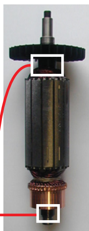
IZOLACJA ŻYWICĄ NA OSI WIRNIKA
